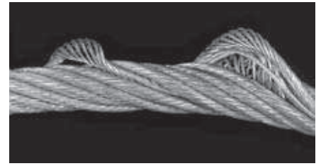
Doppelparallelseile reagieren empfindlich auf Verdrehung. Hier wurden die inneren Litzen verlängert und herausgedrückt.
