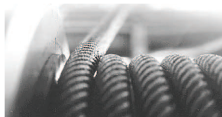
Unter dem Einfluss eines Ablenkwinkels wird das Drahtseil gegen seine Nachbarverwindung gezogen. Die Außendrähte werden an der Berührungsstelle beschädigt ( Seite 12 ).
