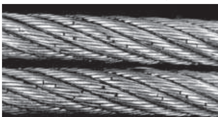
Ermüdungsbrüche auf Stahlseilen mit verdichteten Außenlitzen.
