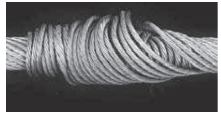
Eine weitere Korbbildung an einem drehungsarmen Seil.
