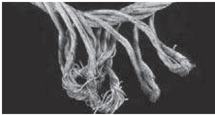
Dieses Drahtseil wurde aufgedreht. Hier sind die Außenlitzen zu lang für das Seil. Eine Seilscheibe hat die Überlängen zu einem Punkt hin massiert, wo die Außenlitzen nun hochstehen.
