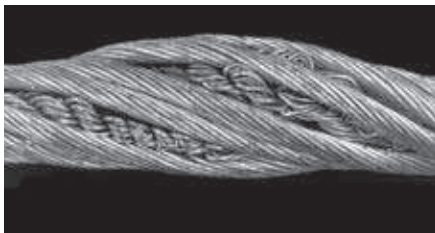
Die durch Verdrehung des Seiles erzeugte Überlänge der Litzen in der Stahleinlage wurde von einer Seilscheibe zu einem Punkt hin massiert. Derartige Schäden finden sich oft am Endpunkt der Seil-Bewegung über Scheibe oder Trommel.
