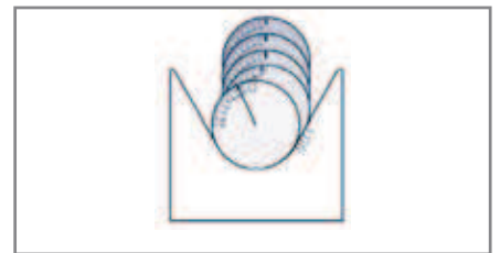
Rillenöffnungswinkel 60°. Deutlich verringerte Seilverdrehung bei einem Ablenkwinkel von 5°.
