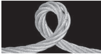
Dieses Seil wurde im seilaufdrehenden Sinn verdreht. Im unbelasteten Zustand bildet das Seil eine Schlaufe im seilzudrehenden Sinn. Wenn das Seil anschließend belastet wird, kann sich die Schlaufe zuziehen und das Seil bleibend verformen.
