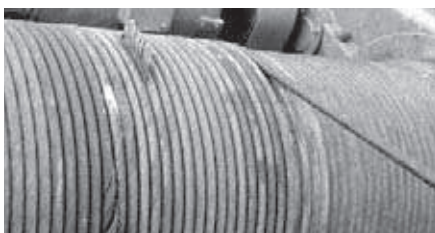
Dieses drehungsarme Seil war an einem frei drehbaren Wirbel befestigt. Bei der Lastaufnahme drehte das Seil auf und lockerte die Außenlitzen. Anschließend liefen aufgedrehte Seilzonen durch die Einscherung, und die Seilscheiben massierten die Überlängen der lockeren Außenlitzen vor sich her. Dies ist ein
