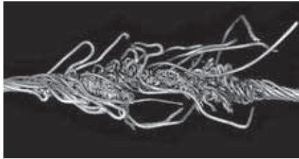
Oft geht Verdrehung nur zu Lasten der innersten (und kürzesten) Litze. Diese ist die einzige gestreckt liegende im Seil.
