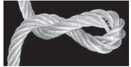
Diese Seil wurde im seilzudrehenden Sinn verdreht. Im unbelasteten Zustand bildet das Seil eine Schlaufe im aufdrehenden Sinn.
