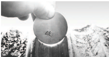
Vermeidung von zu engen Seilrillen. Wenn der Rillenradius zu klein ist, wird das Drahtseil komprimiert. Überflüssige Litzenlänge wird zu einem Punkt hingeschoben. Vorfinden von Litzenlockerung oder Korbbildung ( Seite 12 ).
