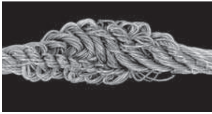
Die Stahleinlage nach Abschälen der Außenlitzen. Die akkumulierten Überlängen sind deutlich sichtbar.
