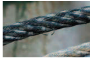
Korrosion der Drähte im Seilbirnenbereich Verguss schließt nicht mit der Außenkante ab
