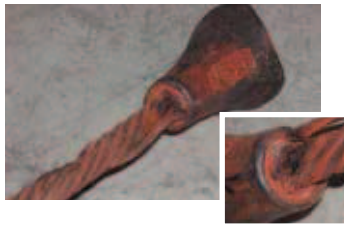
Korrosion der Drähte im Seilbirnenbereich Verguss schließt nicht mit der Außenkante ab
