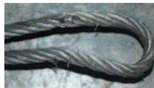
Litzendrahtbrüche in Seilschleufe beim Anschlagseil (durch scharfe Kanten)
