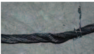
Seilspannung im Seil, Stahlseele herausgedrückt
