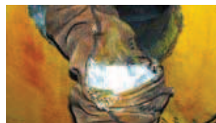
Geschmolzene Rundschlinge (Reibungswärme) durch falsche Anwendung (doppelt gelegt und scharfe Kante)
