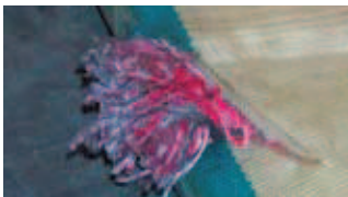
Beschichtetes Hebeband eingerissen
